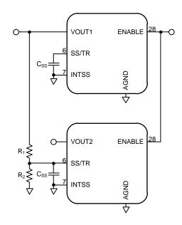
$$R_1 = \frac{V_{OUT2}*12.6}{0.803} (k\Omega)$$
